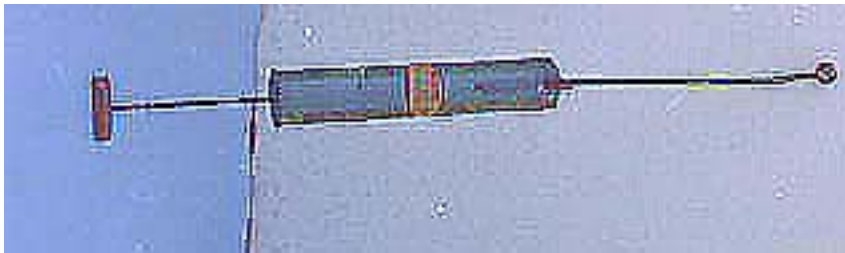
شكل (٤١) عفارة يدوية (عفارة المكبس)
