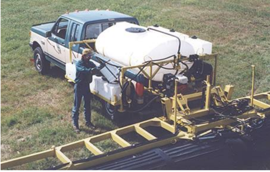
شكل (٣٨) رشاشة هيدروليكية محمولة على سيارة
