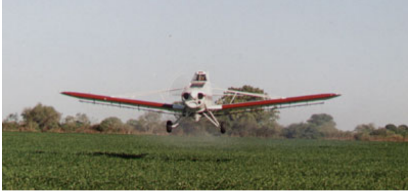
شكل (٣٩) طائرة الجناح الثابت المستخدمة في الرش
